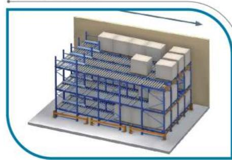
Trong kệ con lăn, hàng hóa được đặt ở phía trước kệ. Khi hàng hóa phía trước được lấy đi, hàng hóa phía sau sẽ tự động đẩy về phía trước. Đó là cơ chế làm việc của kệ con lăn Gravity flow
