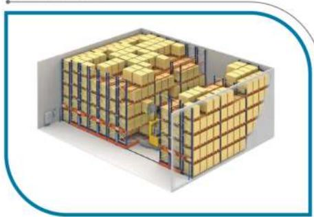
Giá kệ di động là những dãy kệ sắt để hàng nặng được trang bị động cơ cảm biến, động cơ sau khi nhận điều khiển từ xa của trung tâm sẽ đưa ra lệnh chính xác đến vị trí của kệ để đóng/mở lối đi.
