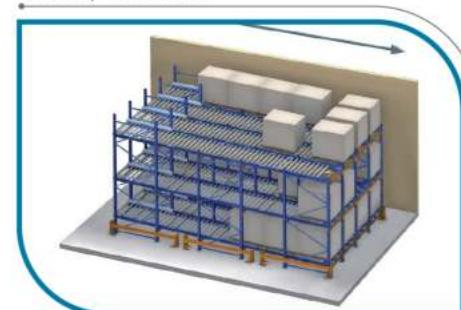
Trong kệ con lăn, hàng hóa được đặt ở phía trước kệ. Khi hàng hóa phía trước được lấy đi, hàng hóa phía sau sẽ tự động đẩy về phía trước. Đó là cơ chế làm việc của kệ con lăn Gravity flow
